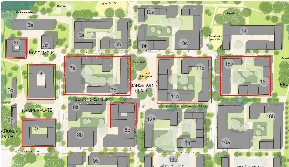
Abbildung 2-40: Gebäudekomplexe mit Verbesserungspotenzial hinsichtlich der Durchlüftung.
